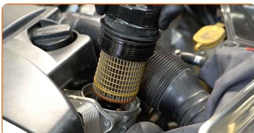
**Výměna: motorového oleje a filtru - MERCEDES-BENZ GL (X164) V6.**
