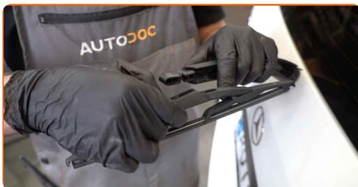
Výměna: stírací lišty - MERCEDES-BENZ GLE SUV (W166). AUTODOC doporučuje:
