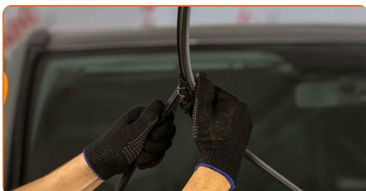
Výměna: stírací lišty - MERCEDES-BENZ SL (R230). AUTODOC doporučuje:
