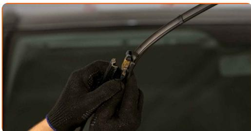
**Výměna: stírací lišty - MERCEDES-BENZ SL (R230). Tip od AUTODOC:**
