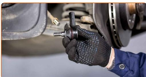
Výměna: kulového čepu řízení - MERCEDES-BENZ SLK (R170). AUTODOC doporučuje:
