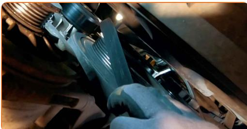
Výměna: drážkového řemene - MERCEDES-BENZ Sprinter 2-T Mikrobus (W901, W902). Doporučují odborníci z AUTODOC:
