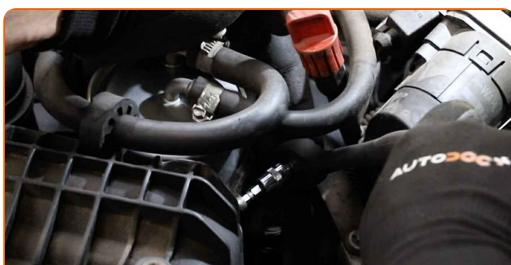
**9** Uvolněte upevňovací svorky trubek palivového filtru. Použijte nástavec č.5.5. Použijte nástavec č.7. Použijte ráčnový klíč.
