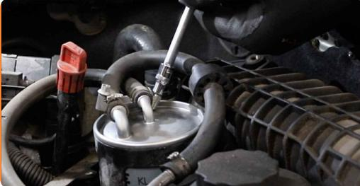
**10** Odpojte trubky od palivového filtru. Použijte kulaté kleště.
