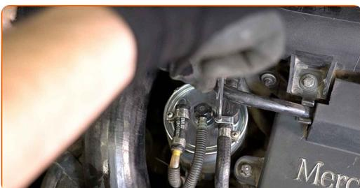
**16** Utáhněte upevňovací svorku trubky palivového filtru. Použijte křížový šroubovák PH.
