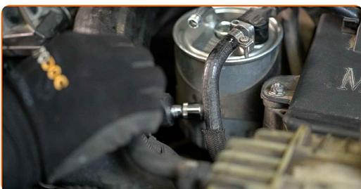
**9** Odpojte přívodní palivové hadičky od palivového filtru.
