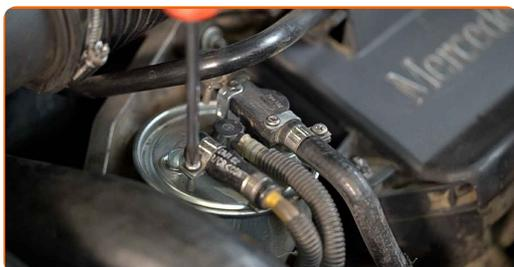
**5** Odpojte trubku z palivového filtru.
