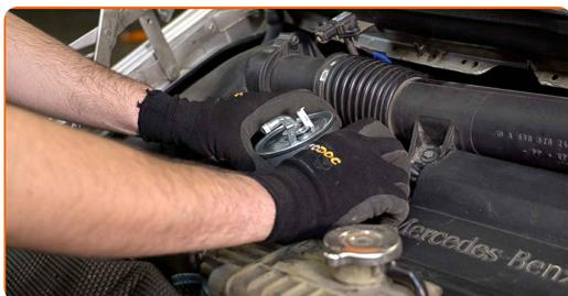
Výměna: palivového filtru - MERCEDES-BENZ SPRINTER 4-t karoserie (904).
