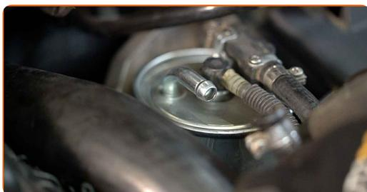
**6** Odstraňte snímač tlaku paliva. Použijte páčidlo.
