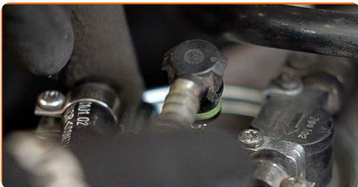
**7** Odšroubujte upevňovací prvek spojující přívodní palivovou hadičku ke krytu palivového filtru. Použijte křížový šroubovák PH.
