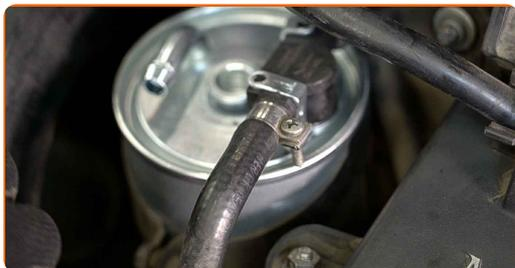
**13** Nainstalujte snímač tlaku paliva.
