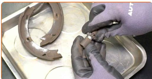
**27** Vyčistěte nastavovač parkovací brzdy. Použijte drátěný kartáč. Použijte víceúčelový čisticí sprej.
