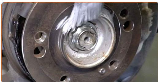
**36** Nainstalujte brzdový kotouč.
