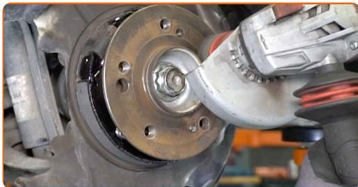
**35** Natřete kontaktní povrch. Použijte keramické mazivo.
