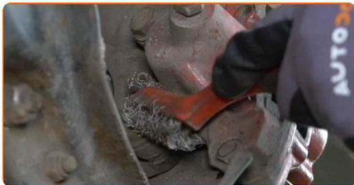
**14** Odšroubujte upevňovací prvky brzdového třmenu. Použijte kombinační klíč č.17.
