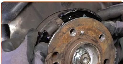
**32** Namontujte přídržné pružiny čelistí parkovací brzdy. Použijte dlouhé kleště.
