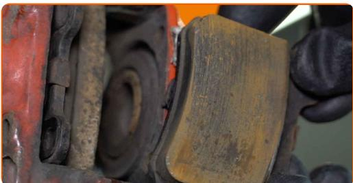
**13** Vyčistěte upevňovací prvky brzdového třmenu. Použijte drátěný kartáč. Použijte sprej WD-40.
