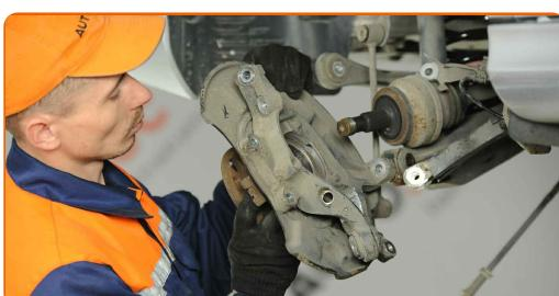
Výměna: ložiska kola - MERCEDES-BENZ Třída C Sedan (W204). AUTODOC doporučuje:
