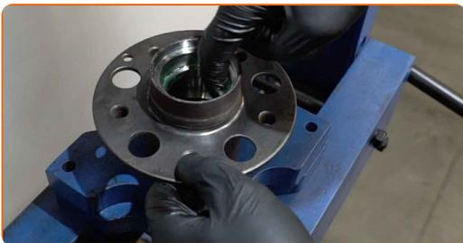
**36** Nainstalujte vnitřní drážku ložiska kola do náboje. Použijte sadu vložky a ořechu ložiska.
