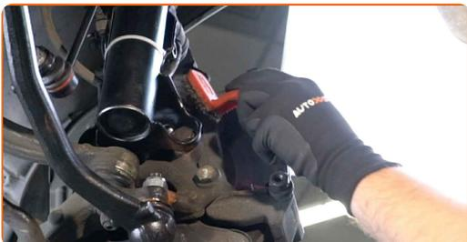
**14** Odšroubujte upevnění svorky brzdového třmenu. Použijte nástavec č.18. Použijte vratidlo. Použijte ráčnový klíč.
