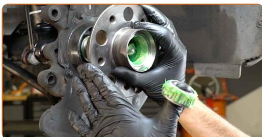
**50** Nainstalujte nové ložisko náboje kola.
