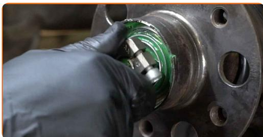
Výměna: ložiska kola - MERCEDES-BENZ Třída C T-modell (S202). Tip:
