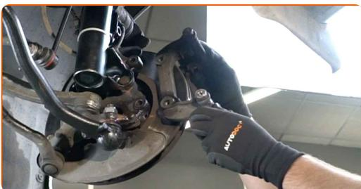
**16** Vyčistěte upeňovací prvky brzdového kotouče. Použijte drátěný kartáč. Použijte sprej WD-40.
