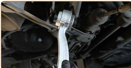
Výměna: přední spodní rameno - MERCEDES-BENZ Třída C T-modell (S204).
