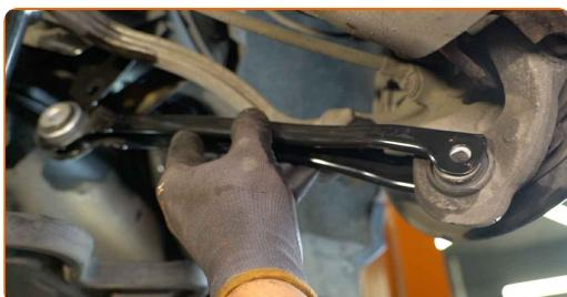
**Výměna: zadní spodní rameno - MERCEDES-BENZ Třída C T-modell (S204).**
