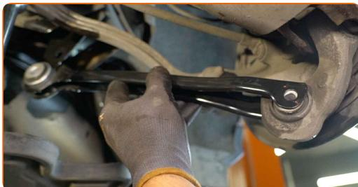
**Výměna: zadní spodní rameno - MERCEDES-BENZ Třída C T-modell (S205).**
