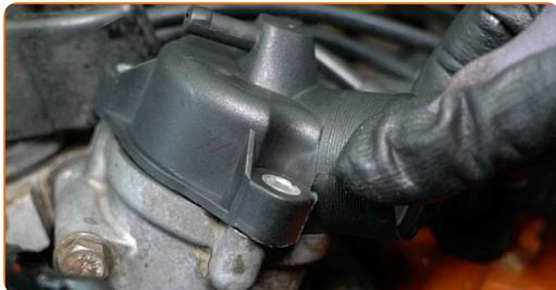
Výměna: termostatu - MERCEDES-BENZ Třída E Kupé (C124). Tip od odborníků z AUTODOC:
