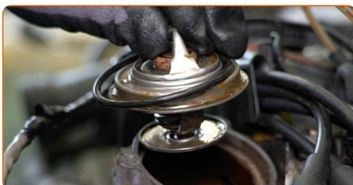
Výměna: termostatu - MERCEDES-BENZ Třída E Kupé (C124). Profesionálové doporučují:
