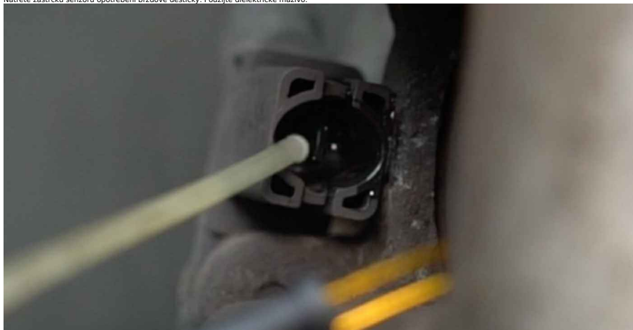
24 Pipněte konektor snímače opotřebení brzdové destičky.
