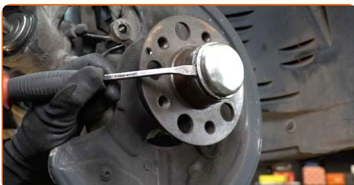
Výměna: ložiska kola - MERCEDES-BENZ Třída E Sedan (W212). Tip od odborníků z AUTODOC:
