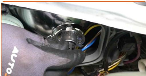
Výměna: žárovky světlometů - MERCEDES-BENZ Třída G SUV Cabrio (W463).
