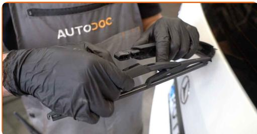
Výměna: stírací lišty - MERCEDES-BENZ Třída ML (W164). AUTODOC doporučuje:
