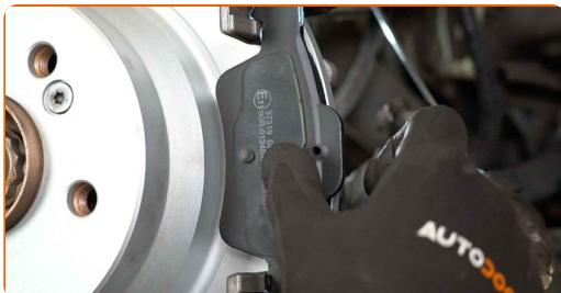
Výměna: brzdové destičky - MERCEDES-BENZ Třída S Kupé (C216). Profesionálové doporučují:
