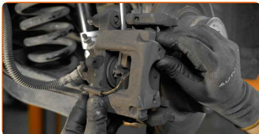
Výměna: senzor opotřebení brzdových destiček - MERCEDES-BENZ Třída S Sedan (W221). Tip:
