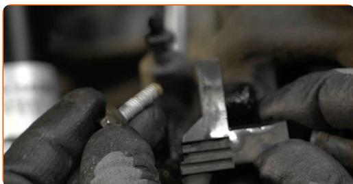
**11** Odpojte kabelový svazek snímače opotřebení brzdové destičky.
