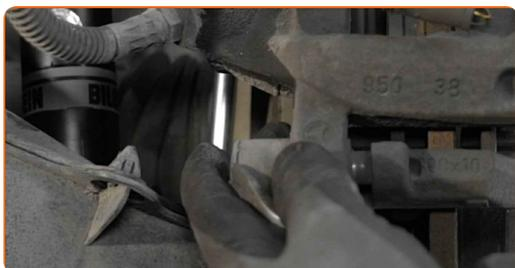
**14** Odšroubujte upevňovací prvky brzdového třmenu. Použijte imbusový klíč č. H7. Použijte ráčnový klíč.
