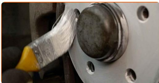
**27** Vyčistěte povrch brzdového kotouče. Použijte čistič brzd.
