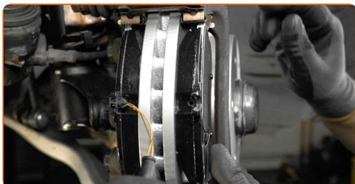
**20** Nainstalujte brzdový třmen a upevněte jej.
