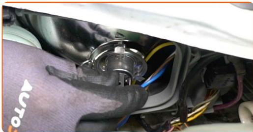
Výměna: žárovky světlometů - MERCEDES-BENZ Třída V (W638/2). AUTODOC doporučuje:
