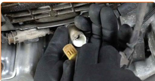
**9** Vyčistěte upevňovací prvek kyslíkového senzoru. Použijte drátěný kartáč. Použijte sprej WD-40.
