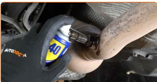
**10** Odšroubujte upevňovací prvek kyslíkového senzoru. Použijte 22-mm nástavec kyslíkového snímače. Použijte ráčnový klíč.
