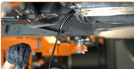
Výměna: motorového oleje a filtru - MERCEDES-BENZ Vaneo (414).
