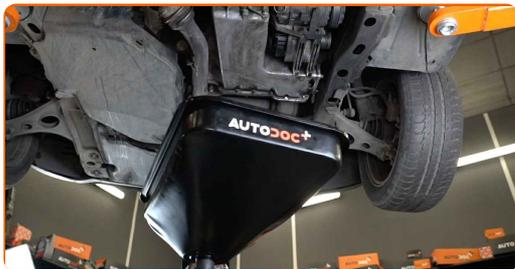
**10** Vyčistěte místo výpustného otvoru olejové vany. Použijte drátěný kartáč. Použijte víceúčelový čistící sprej.
