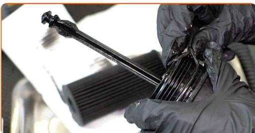
**15** Vyčistěte uzávěr krytu olejového filtru. Použijte víceúčelový čisticí sprej.
