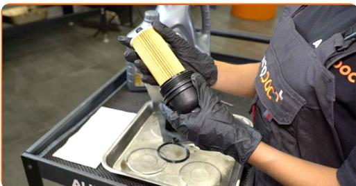
Výměna: motorového oleje a filtru - MERCEDES-BENZ Vaneo (414). Tip od odborníků z AUTODOC:
