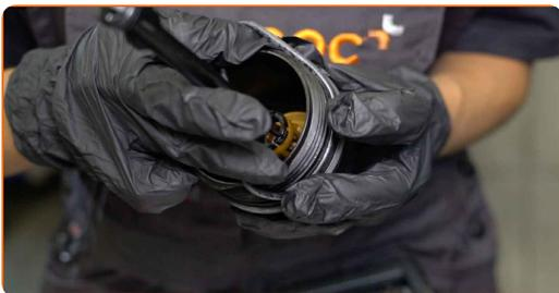
**17** Nainstalujte nový olejový filtr do montážního místa na krytu filtru.
