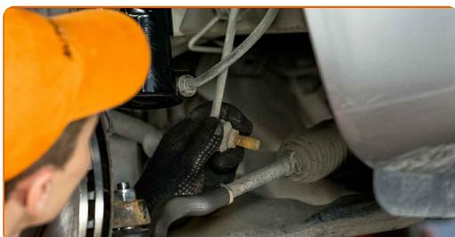
Výměna: tyčky stabilizátoru - MERCEDES-BENZ VIANO (W639). Tip od AUTODOC:
