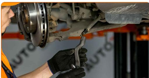
Výměna: kulového čepu řízení - MERCEDES-BENZ VIANO (W639). Tip od AUTODOC:
