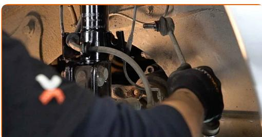
Výměna: tyčky stabilizátoru - MERCEDES-BENZ VITO karoserie (638). Tip od AUTODOC:
