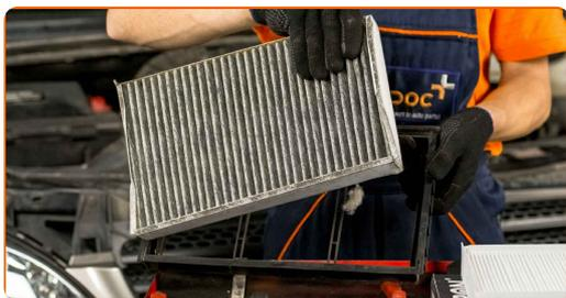
Výměna: kabinového filtru - MERCEDES-BENZ VITO / MIXTO karoserie (W639).
