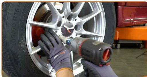
Výměna: parkovací brzdové čelisti - MERCEDES-BENZ W124 Combi (S124).
