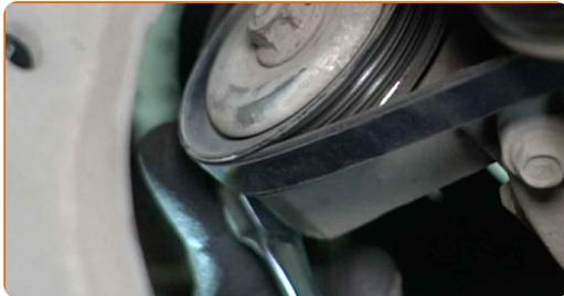
**Výměna: drážkového řemene - Nissan Micra K12. AUTODOC doporučuje:**
