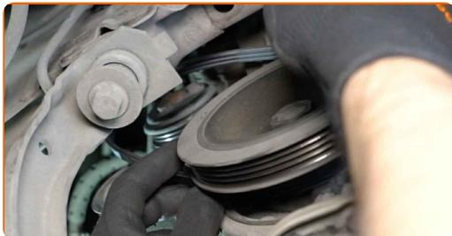
Výměna: drážkového řemene - Nissan Micra K12. Doporučují odborníci z AUTODOC:
