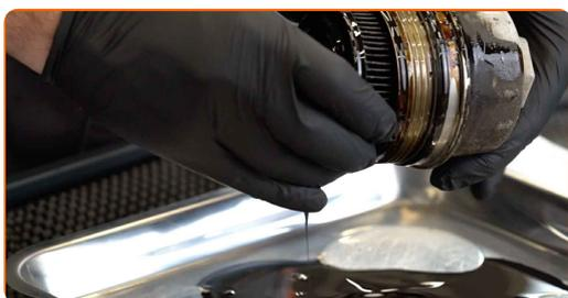
14 Nainstalujte nový o-kroužek na montážní místo na krytu filtru.
