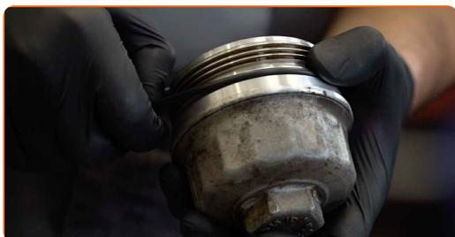
15 Nainstalujte nový olejový filtr do montážního místa na krytu filtru.
