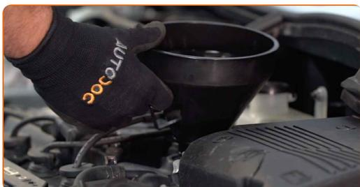
25 Nalijte olej do motoru přes plnicí hrdlo. Potřebné množství oleje: 4.8 l.
