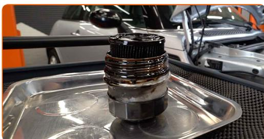
6 Překryjte kryt olejového filtru ručníkem z mikrovlákna, aby se do systému nedostala špína a cizí předměty.
