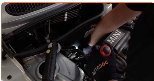
23 Odstraňte uzávěr olejového systému.
