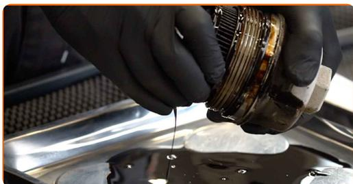
13 Odstraňte o-kroužek krytu olejového filtru.
