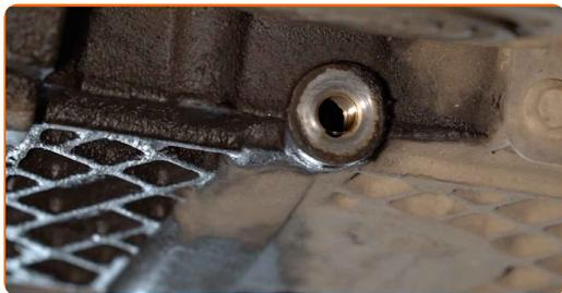
17 Zašroubujte novou zátku výpustného otvoru a utáhněte ji. Použijte nástavec č.13. Použijte momentový klíč. Utáhněte ji točivým momentem 25 Nm.
