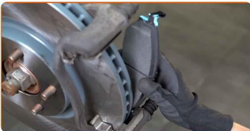
Výměna: brzdové destičky - NISSAN MAXIMA. AUTODOC doporučuje:
