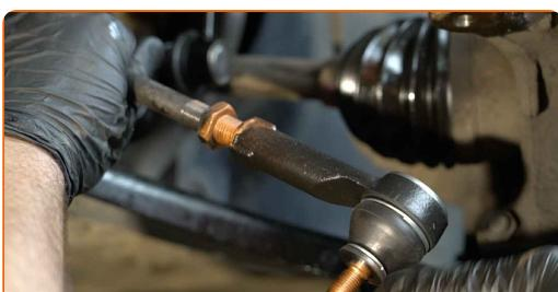
Výměna: kulového čepu řízení - NISSAN Micra C+C III (K12). Tip od AUTODOC:
