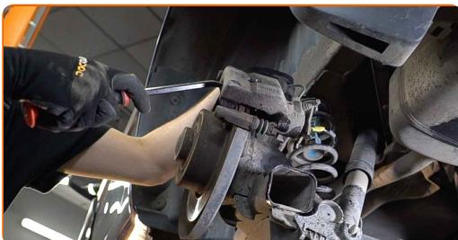
Výměna: brzdové destičky - NISSAN MICRA III (K12). Doporučují odborníci z AUTODOC:
