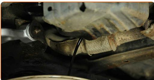
Výměna: motorového oleje a filtru - NISSAN NP300 Navara Pick-up (D23). Tip od AUTODOC:
