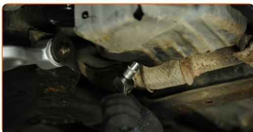
**10** Vyčistěte místo výpustného otvoru olejové vany. Použijte víceúčelový čisticí sprej.
