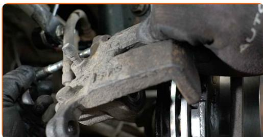
**20** Nainstalujte vodící kolíky brzdového třmenu.
