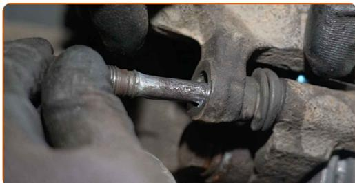
**21** Utáhněte upevňovací prvky brzdového třmenu. Použijte nástavec č.14. Použijte momentový klíč. Utáhněte ji točivým momentem 32 Nm.
