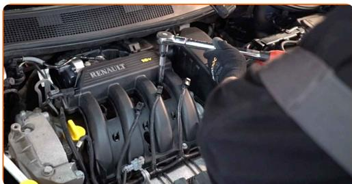
Výměna: zapalovacích svíček - NISSAN Terrano III (D10). Tip:
