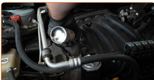
**4** Nainstalujte uzávěr olejového systému.
