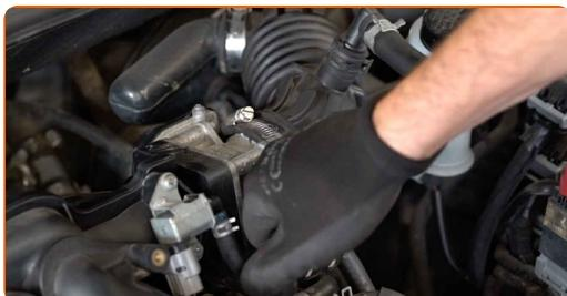
4 Odšroubujte držáky a upevnění přívodní hadice vzduchového filtru. Použijte nástavec č.10. Použijte ráčnový klíč.
