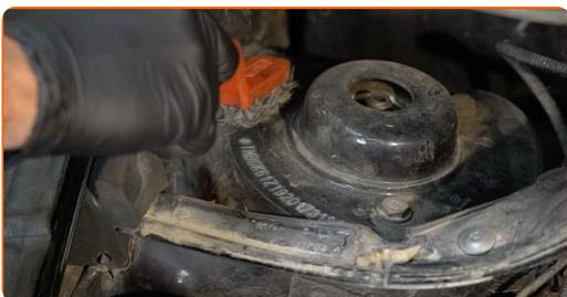
**6** Uvolněte vrchní upevňovací prvek ložiska vzpěry tlumiče. Použijte nástavec č.13. Použijte ráčnový klíč.
