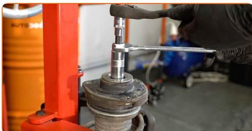
**35** Odstraňte uložení tlumiče, návlek a tlumící doraz.
