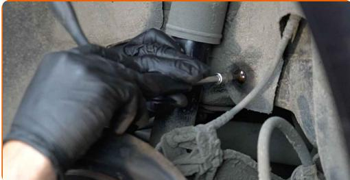
8 Vyčistěte upevňovací prvky tlumiče. Použijte drátěný kartáč. Použijte sprej WD-40.
