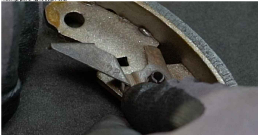
34 Nainstalujte pojistný kroužek.
