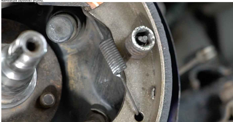
40 Nainstalujte horní zpětnou pružinu. Použijte dlouhé kleště.
