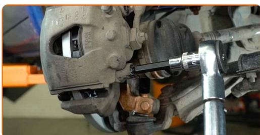
**19** Nainstalujte krytky prachového pouzdra vodících závlaček brzdového třmenu.
