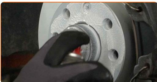
**23** Vyčistěte povrch brzdového kotouče. Použijte čistič brzd.
