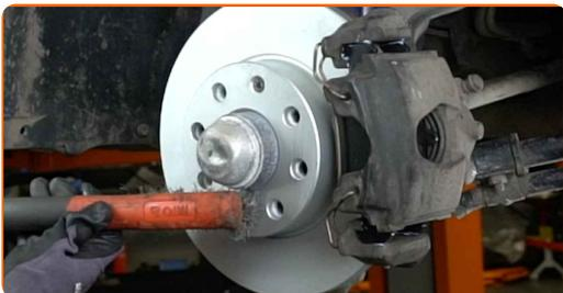
**22** Natřete povrch, kde je brzdový kotouč v kontaktu s ráfem kola. Použijte vysokoteplotní keramické mazivo.
