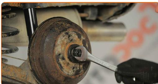
**24** Nainstalujte závlačku upevňovací matici ložiska náboje. Použijte kulaté kleště.
