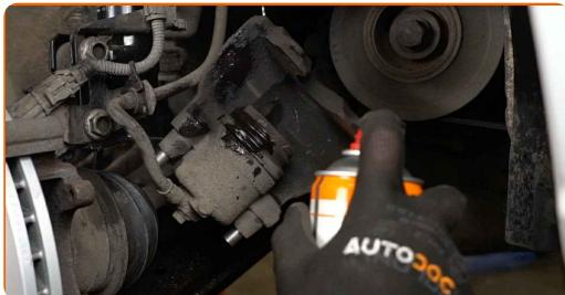
Výměna: brzdové destičky - OPEL Astra G Kupé (T98). Tip od odborníků z AUTODOC:
