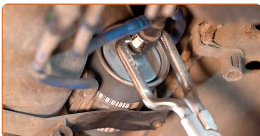
Výměna: palivového filtru - OPEL Astra G Van (F70). AUTODOC doporučuje:
