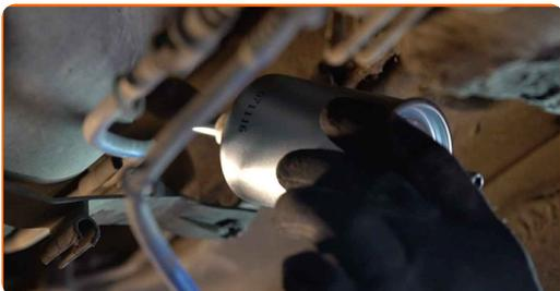
10 Utáhněte upevňovací prvky palivového filtru. Použijte hvězdicový Torx T 20.
