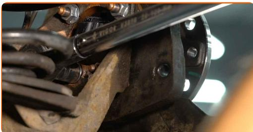
Výměna: ložiska kola - OPEL Astra H GTC (A04). Tip od odborníků z AUTODOC:
