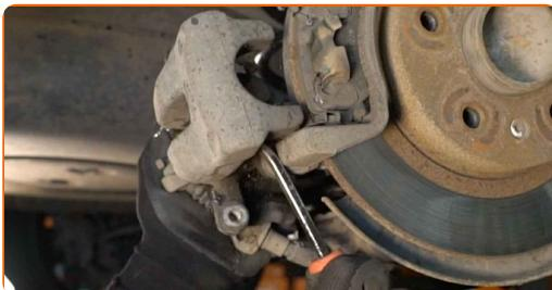
Výměna: ložiska kola - OPEL Astra H GTC (A04). Doporučují odborníci z AUTODOC:
