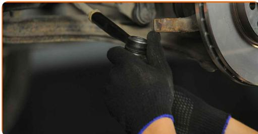
Výměna: kulového čepu řízení - OPEL Astra H Sedan (A04). AUTODOC doporučuje:
