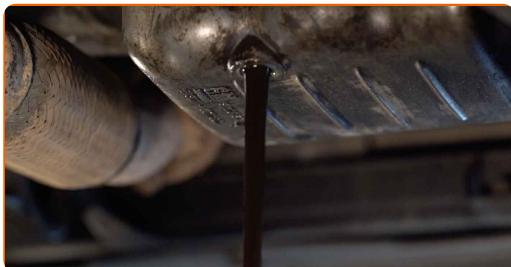
**Výměna: motorového oleje a filtru - OPEL Combo C Van / Combi.**
