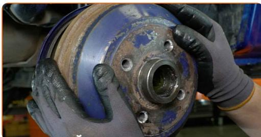
Výměna: ložiska kola - OPEL Corsa A Van (S83). Tip od AUTODOC:
